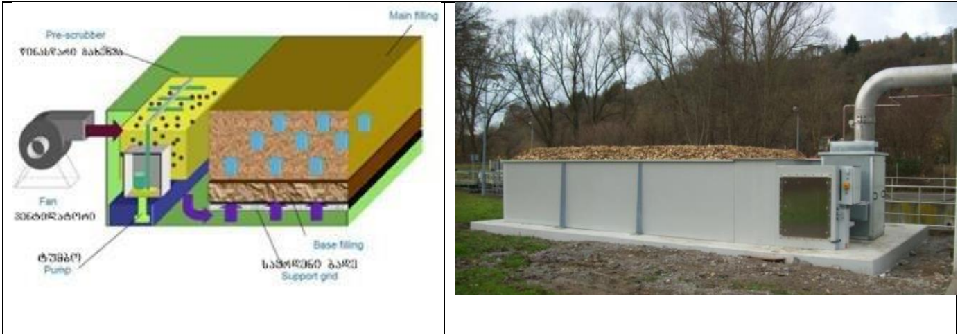
სურათი 3-12: ტიპური ბიო-ფილტრი წინასწარი საწმენდით
